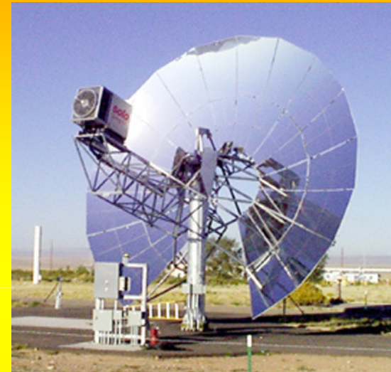
Esempio di concentratore a parabola da 30 kW
